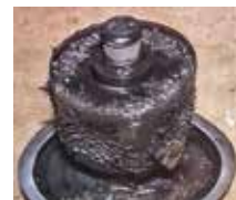
Slika 4: Obloge magnetita na trajnem magnetu varčne obtočne črpalke
