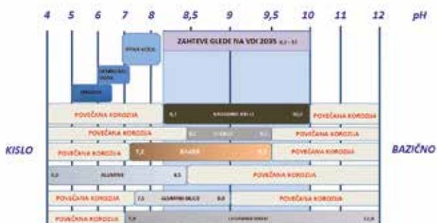
Slika 3: Občutljivost materialov na korozijo glede na pH vrednost
