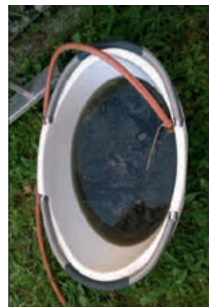
Degradiran in zamuljen glikol izpuščen iz solarnega sistema (vir: privatni arhiv Boris Gojkošek)
