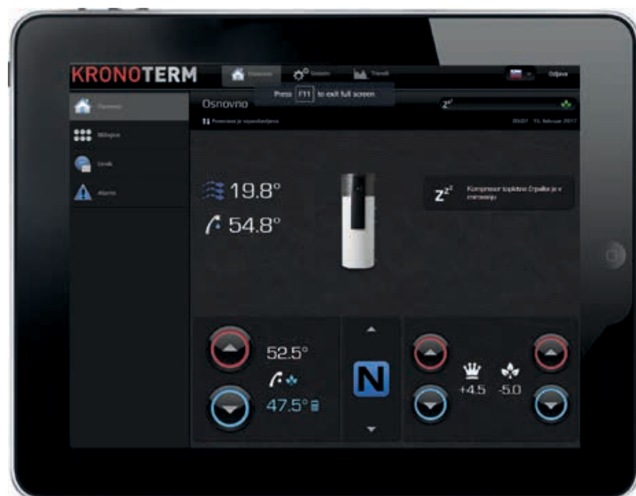
Možnost priklopa Kronoterm toplotne črpalke na internet; enostavno upravljanje in servis na daljavo z aplikacijo Water.Kronoterm.
