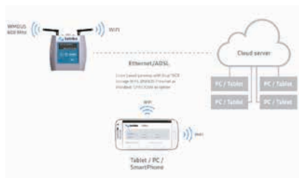
Nadzor delovanja posameznega PV panela se izvaja lokalno ali v oblaku
