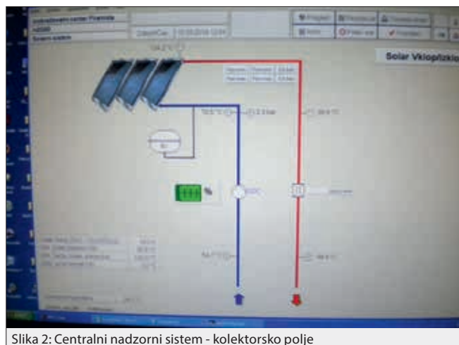
Slika 2: Centralni nadzorni sistem - kolektorsko polje
