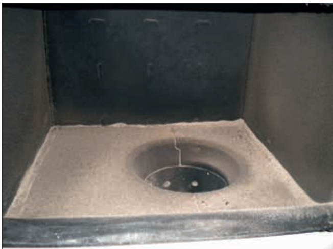
Slika 7: Zgorevalna komora iz termične keramike
