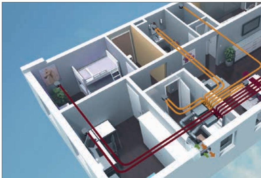
Slika 2: Prezračevalni sistem Helios KWL je zasnovan tako, da svež zrak dovajamo v čiste prostore, obremenjenega pa odvajamo iz sanitarij, kopalnice in kuhinje.
