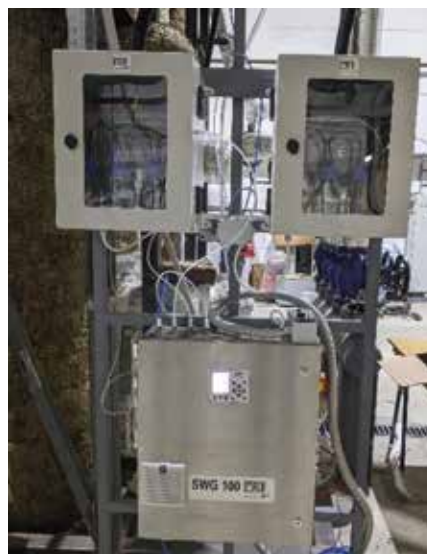
Slika 1 Stacionarni sistem MRU SWG100 Syngas za analizo pri proizvodnji vodika v Mariboru
