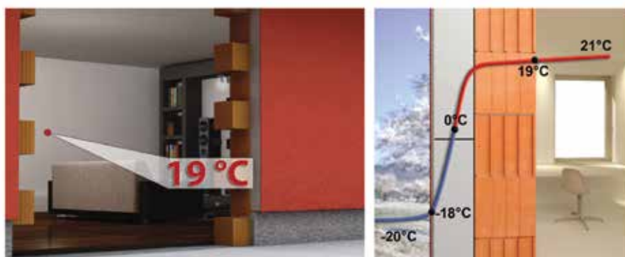
PROSTOR Z IZVEDENO TOPLLOTNO IZOLACIJO
