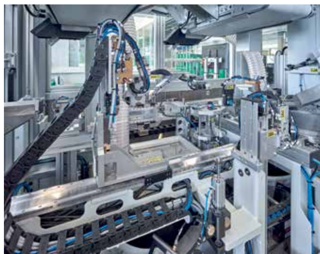
Nov koncept proizvodnje združuje vse delovne korake – od granulata do zapakiranega fittinga – v en sam proces.
