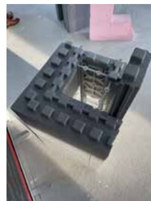
Vgradnja betona v opažne elemente iz ekspaniranega polistirena - sistem JUBHome temelji na ICF tehnologiji
