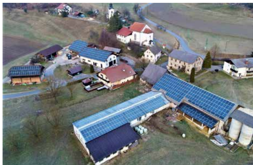
MFE Starina – Pet sončnih elektrarn na kmetijskih poslopih v Jagnjenici v skupni moči 173 kW.
