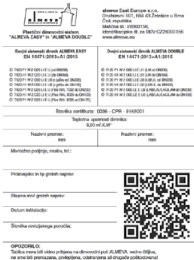
Slika 2: Primer napisne tablice ene izmed dimovodnih naprav, ki je samostojen gradbeni proizvod po Uredbi EU 305/2011 o gradbenih proizvodih
