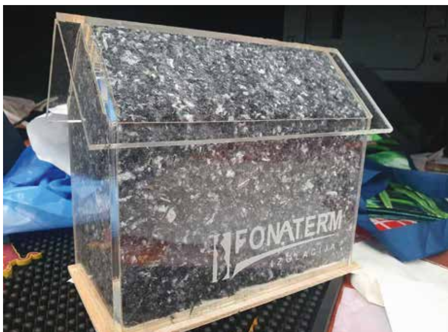
Prikaz vpihane granulacije – izolacije Fonaterm
